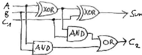
Dabei sind A, B, und  $C_1$  logische inputs (d.h.  $A \in \{\text{true, false}\}$  bzw.  $A \in \{0, 1\}$  usw) und Sum und  $C_2$  logische outputs. Zeige mit einer Wahrheitstabelle, das diese Schaltung die binäre Addition (Sum) vom A und B ausführt, mit einem Übertrag  $C_2$ .  $C_1$  ist ein möglicher Übertrag von einer vorherigen Addition. Wie könnte man mehrere dieser Schaltungen kombinieren, um natürliche Zahlen (in Binärdarstellung) grösser als 1 zu addieren?
